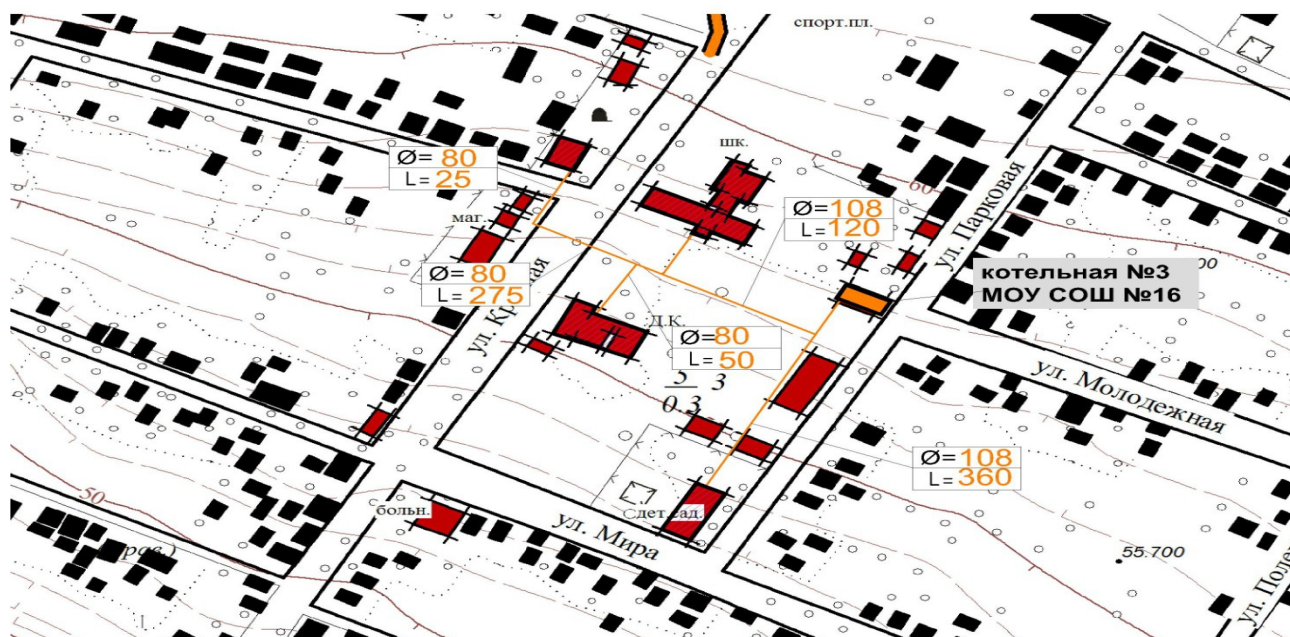
Рис. 1. Схема тепловых сетей в Иркиевском СП.
